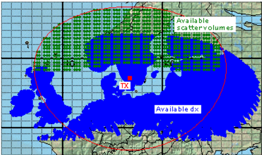
Abb 3. Mögliche Rückstreuzentren (Punkte) und maximale DX Reichweite (Fläche) bei Aurora- und FAI-Funkverbindungen. Man beachte, dass die punktförmigen Markierungen Gebiete in der Ionosphäre (105 km) beschreiben, die zusammenhängende Fläche jedoch Positionen am Erdboden kennzeichnet.
